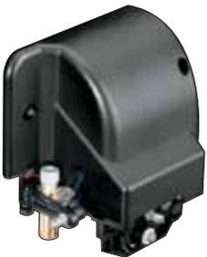
Seine Einfachheit hat das **Schleppmesser** zur meist genutzten Technik gemacht. Ein Ausgleichswert (Offset) definiert die Distanz von der Messerspitze zum Rotationszentrum. Um die Ausrichtung der im Halter frei rotierenden Klinge zu bestimmen, wird eine Schleppbewegung gemacht, welche die Klinge dann ausrichten soll. Die Summa Schneideplotter verfügen hierzu über eine gesteigerte Technik zur Klingenausrichtung, um dadurch die best mögliche Schneidequalität zu erhalten.
