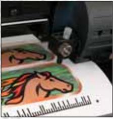
OPOS ist das zuverlässige **optische System** zum automatischen Konturschneiden für das Produzieren von Aufklebern. Es erhöht die Produktivität der Arbeitsläufe beim vielfachen Schneiden von Konturen.
