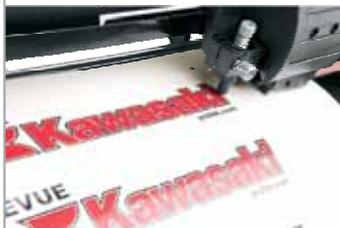
Innovative **Mediaflansche** in Verbindung mit der besonders präzisen **Rollenhalterung** gewährleisten ein gerades Führen der Folien, sogar bei Höchstgeschwindigkeit.
